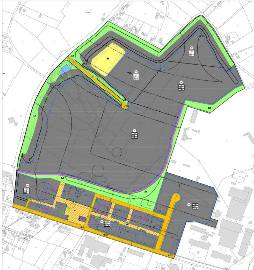
Die Erschließung der Gewerbe- und Industrieflächen erfolgt von Süden über mehrere Anknüpfungspunkte der Osnabrücker Straße, welche im Süden des Plangebietes in Ost-West Richtung verläuft. Die Haupteerschließungsachse verläuft im Bereich des „Tor West“ von dem die Gewerbeflächen entlang der Osnabrücker Straße erschlossen werden. Zusätzlich wird im Nordwesten eine weitere Erschließungsachse (der sog. „Landabsatz“) festgesetzt.
