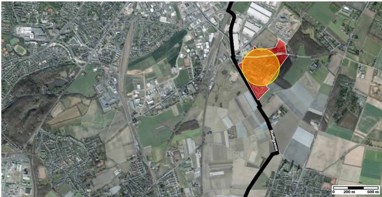
**Abbildung 15: Kontur des angemessenen Sicherheitsabstandes für den Betriebsbereich der Firma Orion Engineered Carbons GmbH, Werk Kalscheuren**
