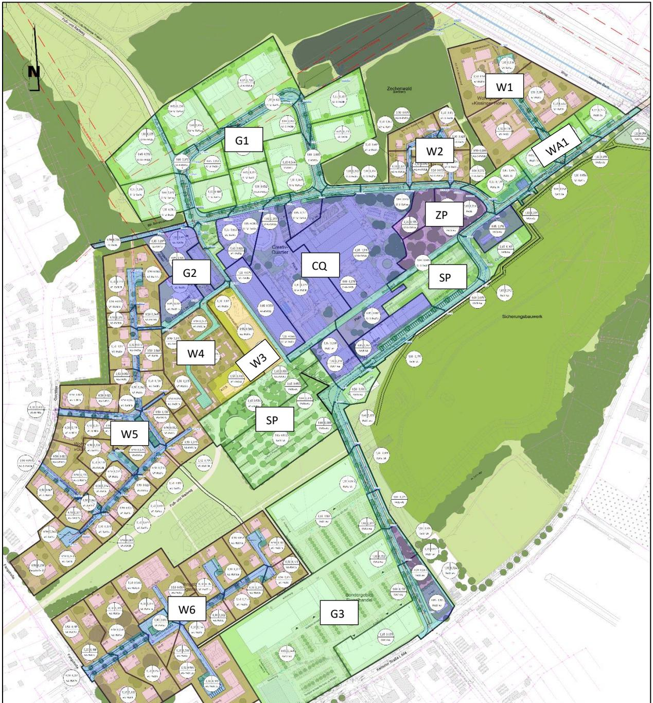
Abbildung 11: Übersicht Einzugsgebiet aus Lageplan Regenwasser Einzugsgebiete
