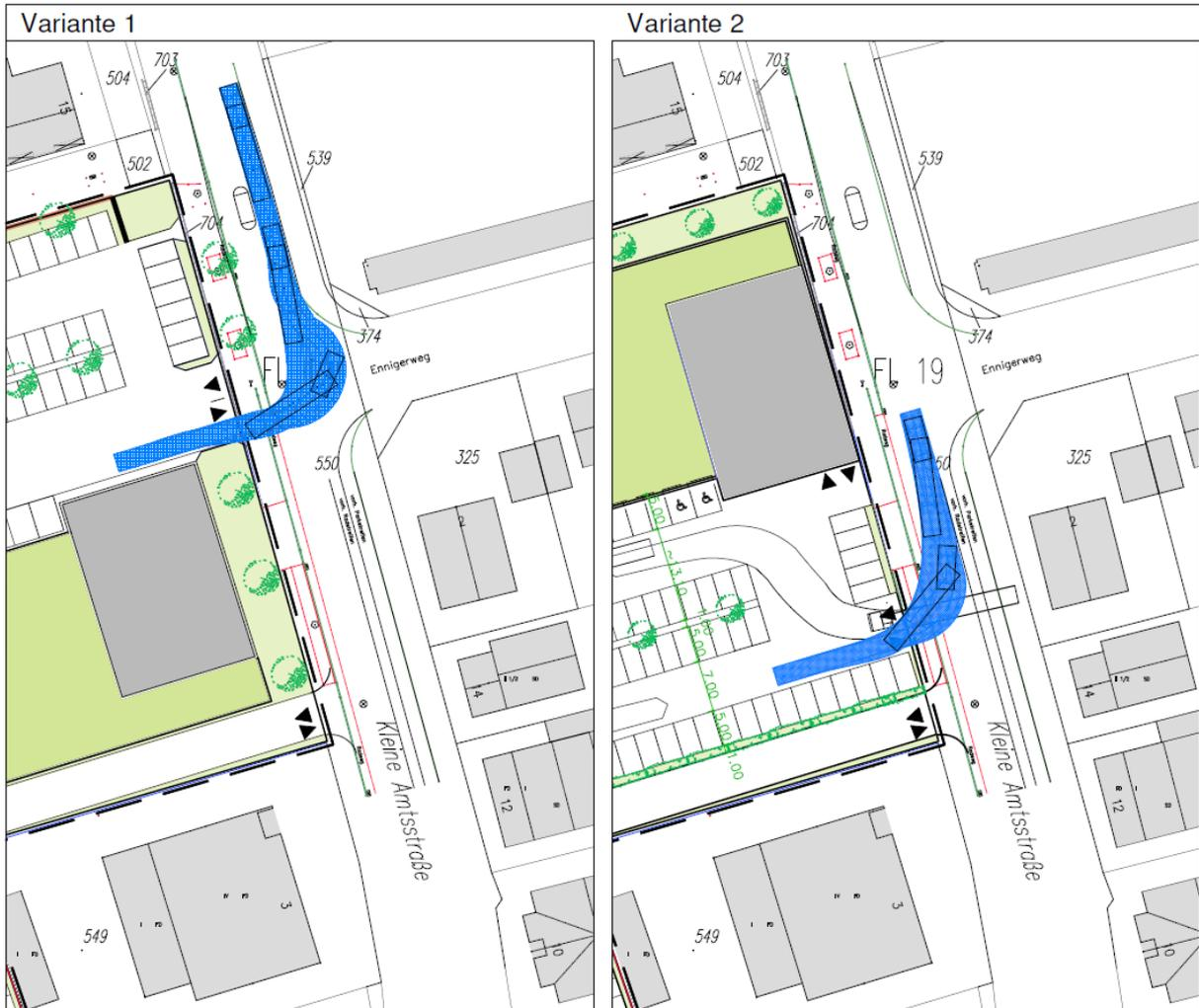
**Abbildung 7:** Schleppkurven der Lkw-Ausfahrt
