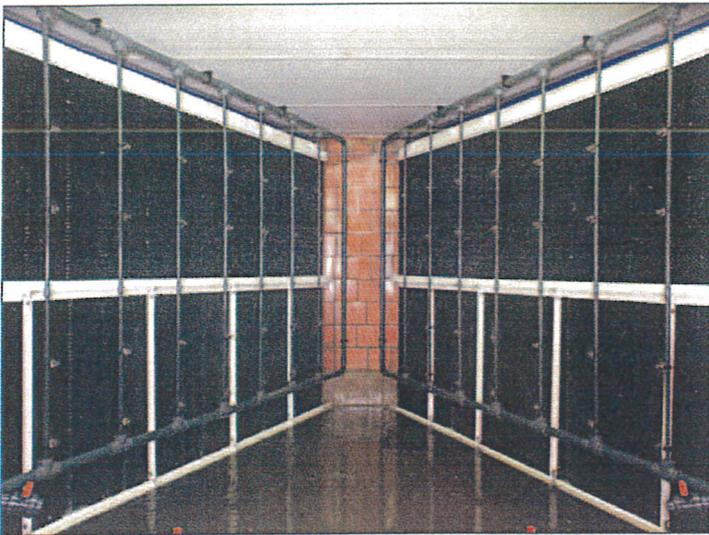
Die Düsendruppe sprüht Wasser auf die Vorderseite der Filterwand
