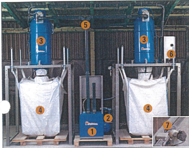
Staub-Absauganlage zur halbautomatischen Reinigung des Filters StuffNix
