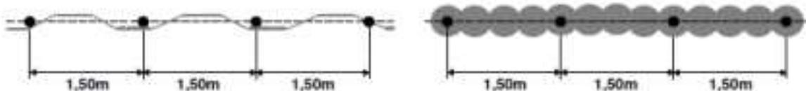
**Abbildung 1.1:** Beispiele für die Anordnung der Bohrpunkte bei Spundwänden, Bohrpfehlwänden, Schlitzwänden, Verankerungen und ähnlichem. Eine eindeutige Bezeichnung der Bohrpunkte ist festzulegen.
