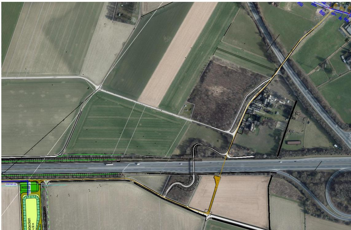
Abbildung 31: Darstellung Variante 3 "Freispiegelleitung südlich der Fußgängerbrücke"
