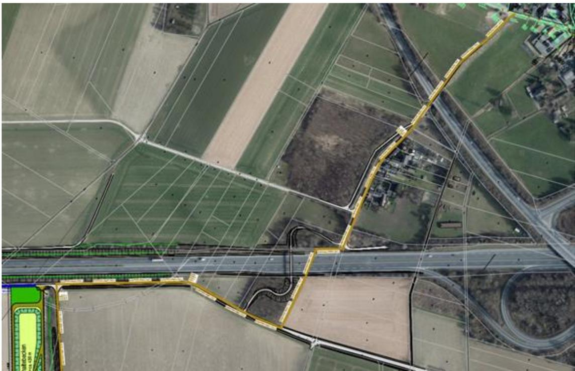
Abbildung 30: Darstellung Variante 2 "Freispiegelleitung südlich der Fußgängerbrücke "
