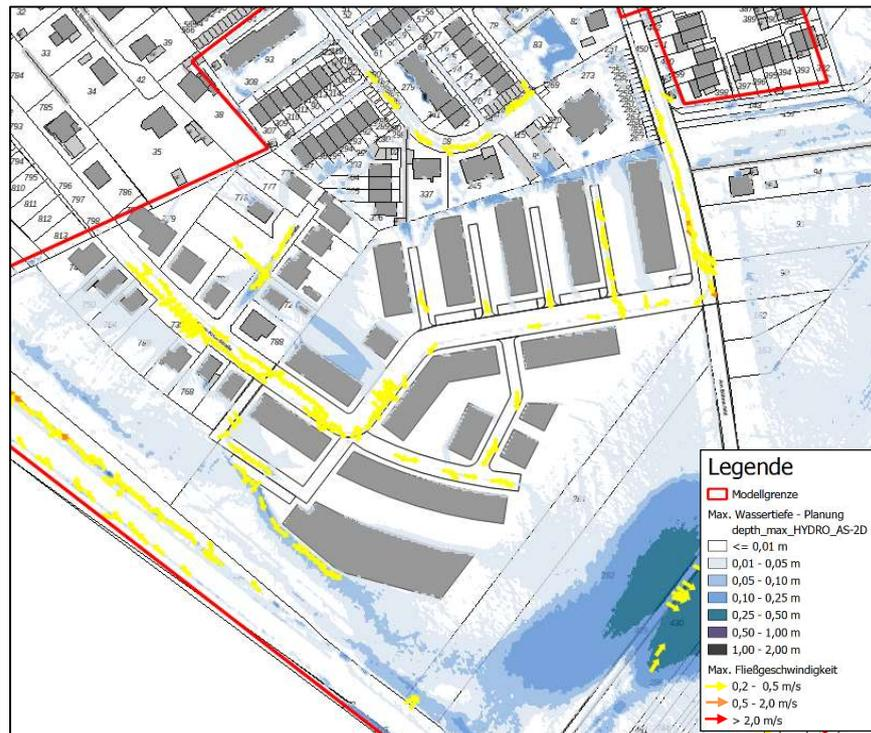
**Abbildung 5.2: Ausschnitt aus dem Modellgebiet: Fließgeschwindigkeiten im BP-Gebiet W57**
