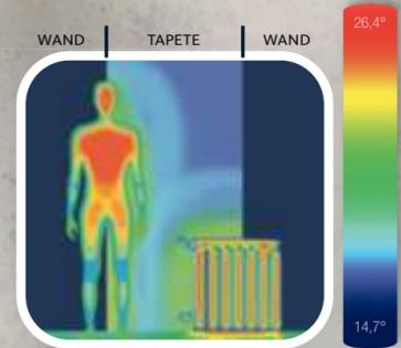
CELSIUS enthält Aluminiumpigmente, die Wärmestrahlung in einen Raum zurückreflektieren.
