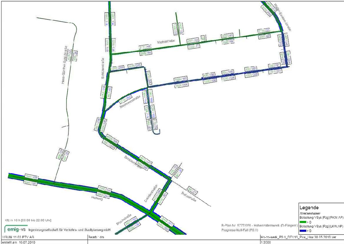
Abbildung 4-4: Prognose-Fall 0.1- Verkehrsbelastungen DTV [Pkw/16 h] und [Lkw/16 h]
