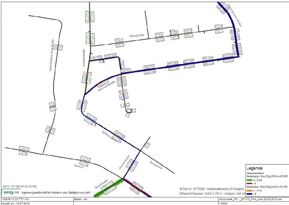
Abbildung 4-5: Differenzbelastung Prognose-Fall 0.1 abzgl. Analyse-Fall DTV [Pkw/16 h] und [Lkw/16 h]
