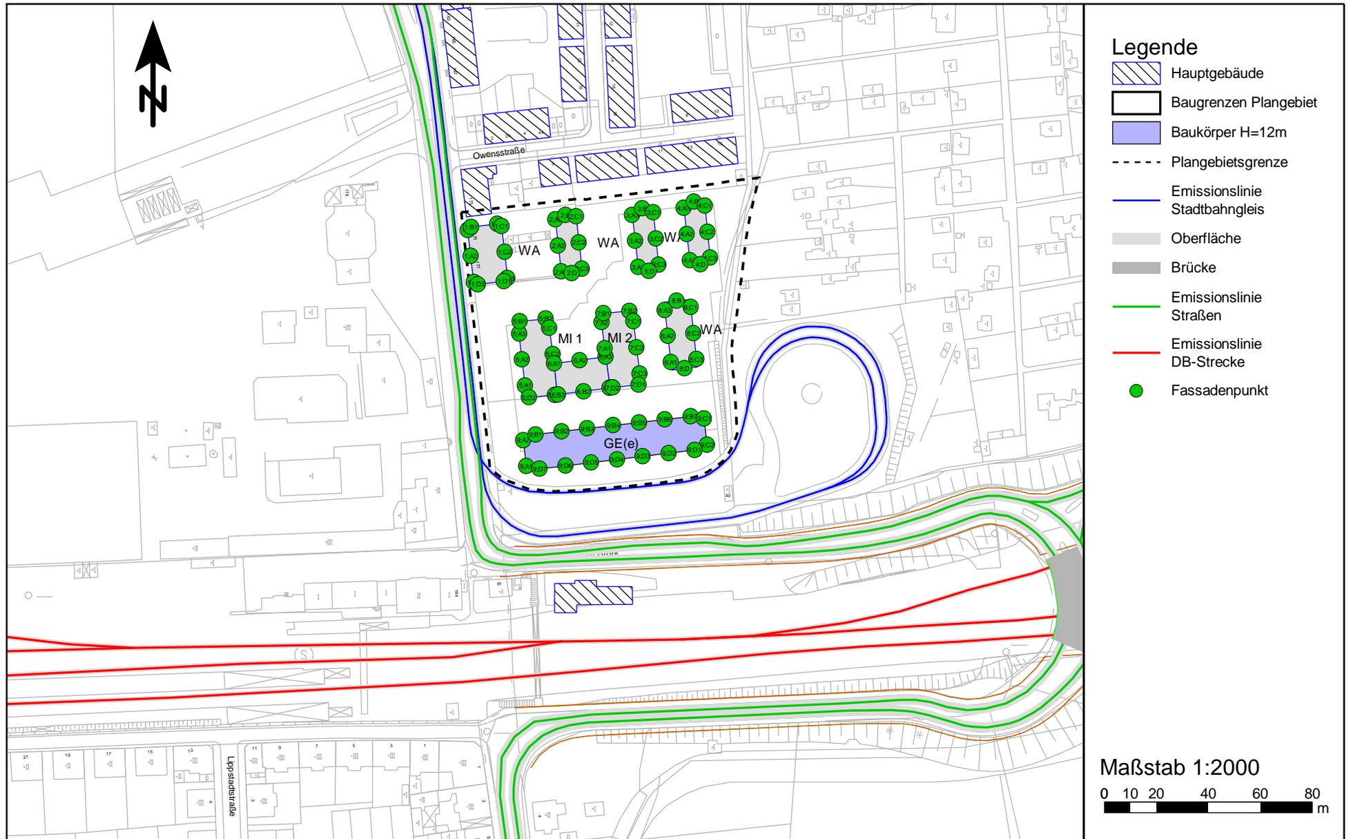
Lageplan des digitalen Simulationsmodells für die bestehende Straßensituation (Prognose "Ohne-Fall")
