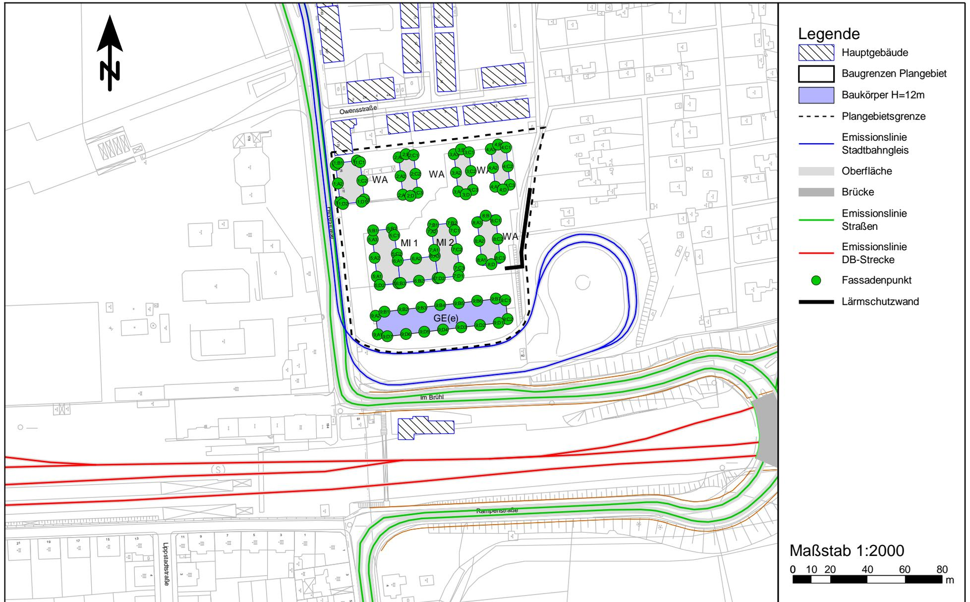
Lageplanausschnitt des digitalen Simulationsmodells (Prognose "Ohne-Fall")
