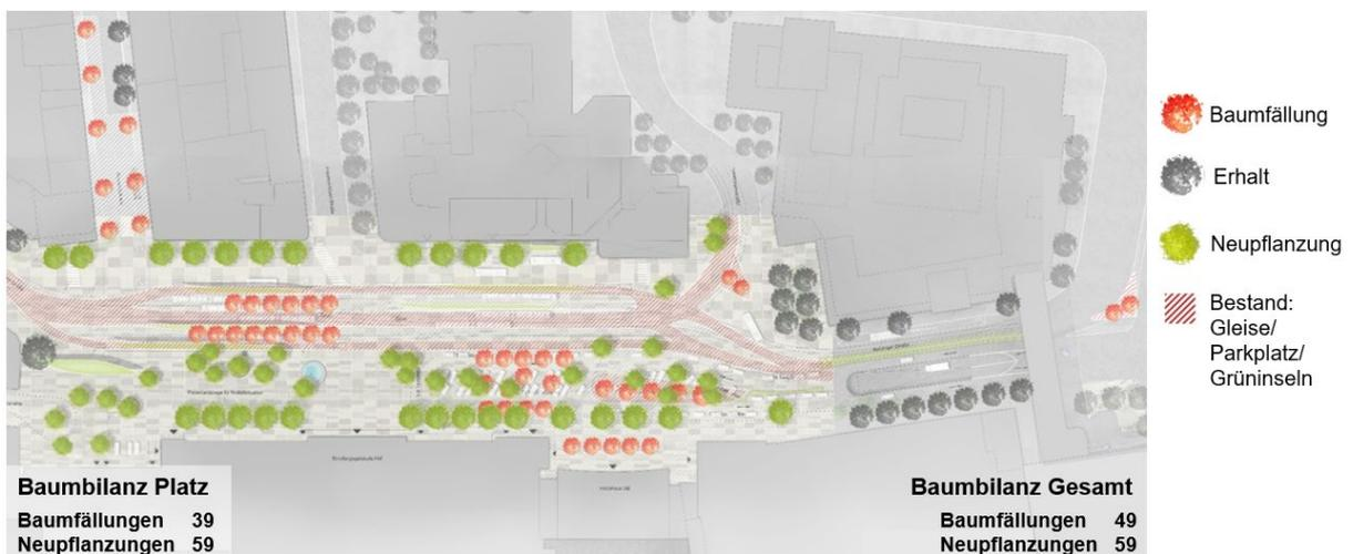
Für die Bereiche der Bismarckstraße und der Tiefgarage (DB S&S) konnten planerisch keine Varianten gefunden werden, da die räumliche Einschränkung keine alternative Lage zulässt: Die Tiefgarage der DB S&S dient als Nachweis der Stellplätze für das geplante Hochhaus. Die Erschließungsanlagen in der Bismarckstraße sind im jetzigen Planungsstadium in ihrer Grundfläche bereits minimiert.
