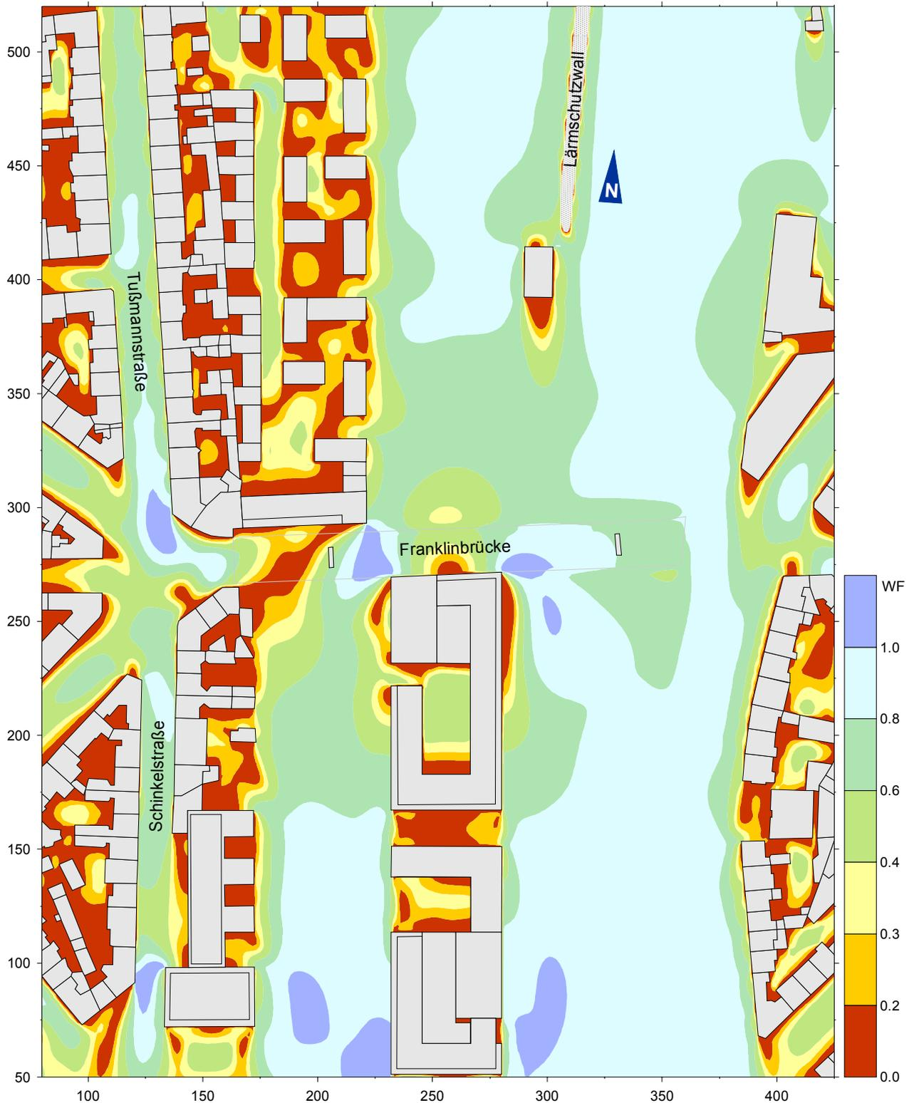
**Abb. 8.2:** Planvariante 1 - Bodennahes Windfeld bei einem übergeordneten Wind aus 350°
