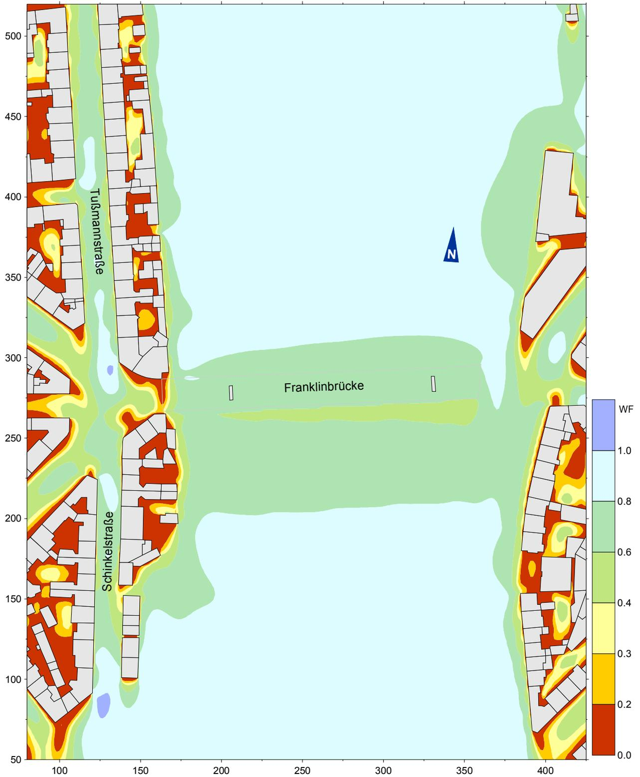
**Abb. 8.1:** Istzustand - Bodennahes Windfeld bei einem übergeordneten Wind aus 350°
