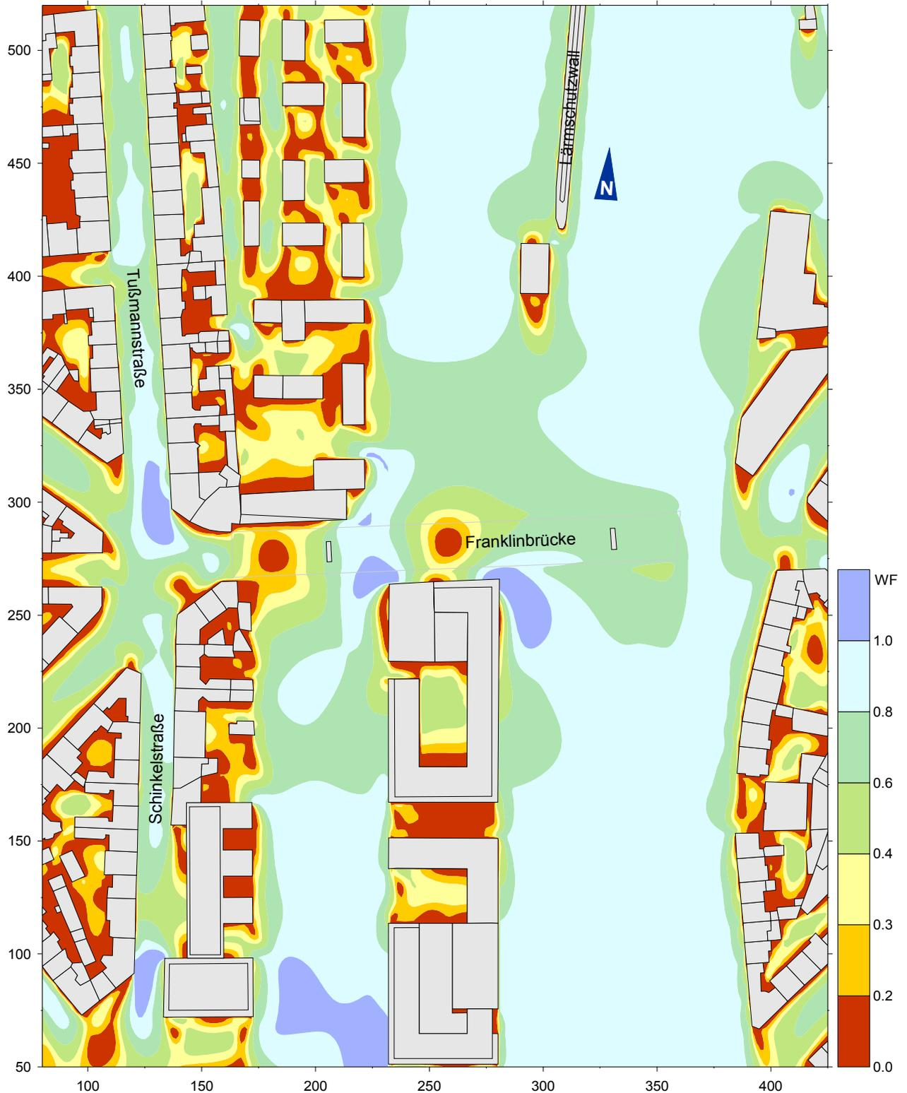
**Abb. 8.3:** Planvariante 2 - Bodennahes Windfeld bei einem übergeordneten Wind aus 350°
