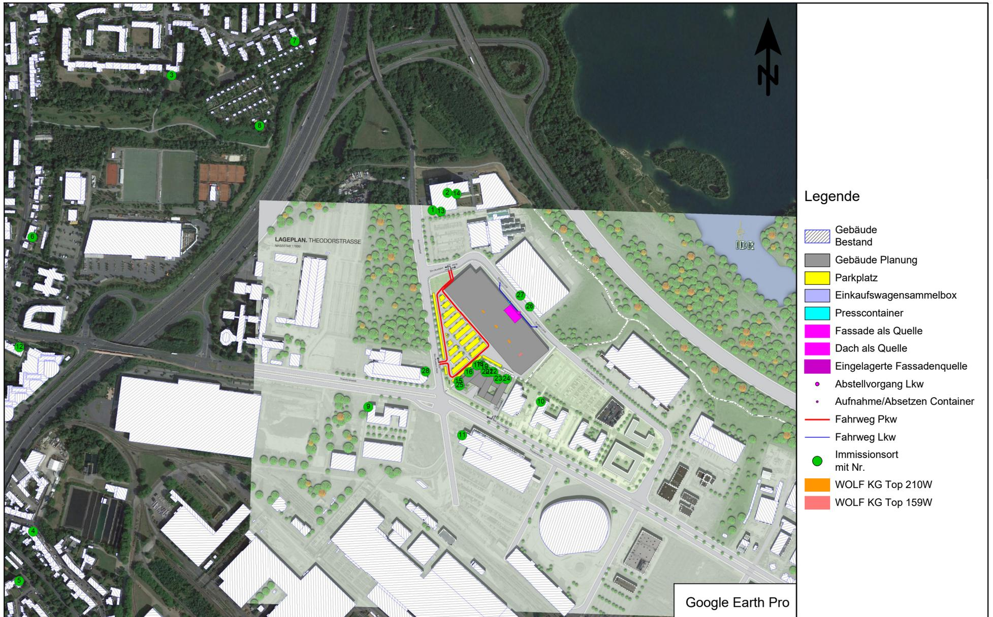
Lageplanausschnitt des digitalen Simulationsmodells "Gewerbelärm" mit Darstellung des geplanten Bau- und Gartenfachmarktes und Kennzeichnung der lfd. Nummer der berücksichtigten Emissionsquellen
