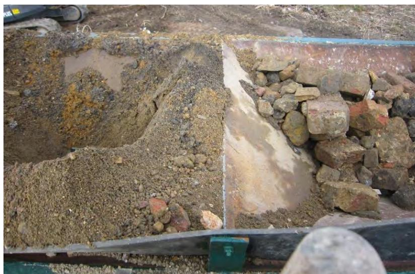
**Abbildung 3: Verstopfungen Trichtervorrichtung**
