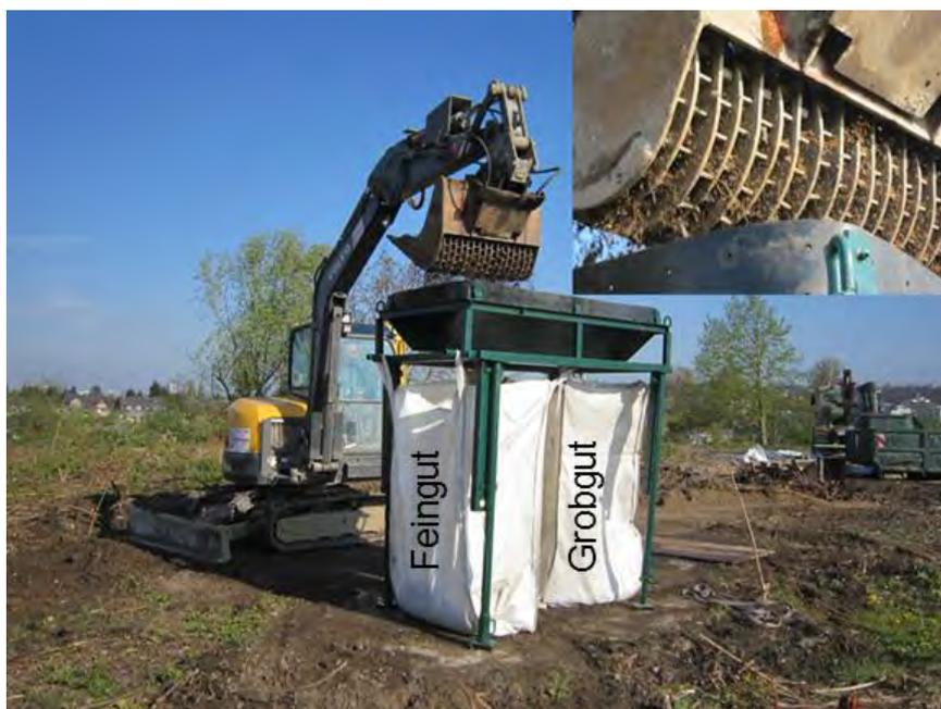
**Abbildung 2: Mobiler Bagger mit Siebschaufel**
