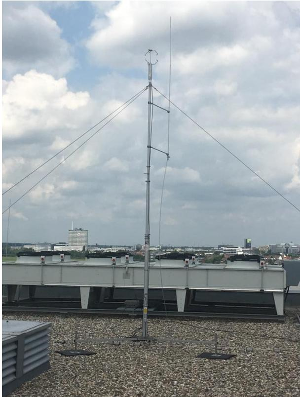
Abbildung 10: Meteorologische Messstation auf dem Gebäude Plange Mühle Nr.1
