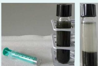
Bei der Elution stellt sich ein Gleichgewicht zwischen dem Feststoff/Bodenmaterial  $C_F$  und dem Wasser  $C_L$  ein.
