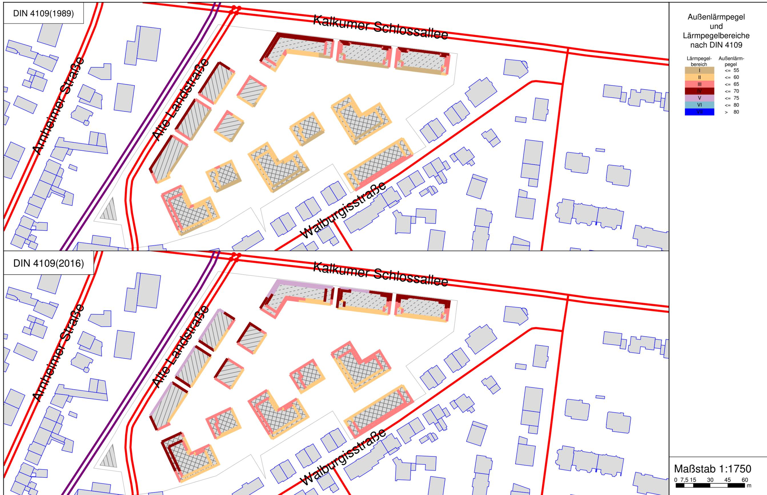
Anlage 6.1: Ergebnisse der Immissionsberechnung. Beurteilungspegel im Plangebiet durch Verkehrslärm in Form einer Rasterlärmkarte, Rechenhöhe= 8 Meter über Gelände.
