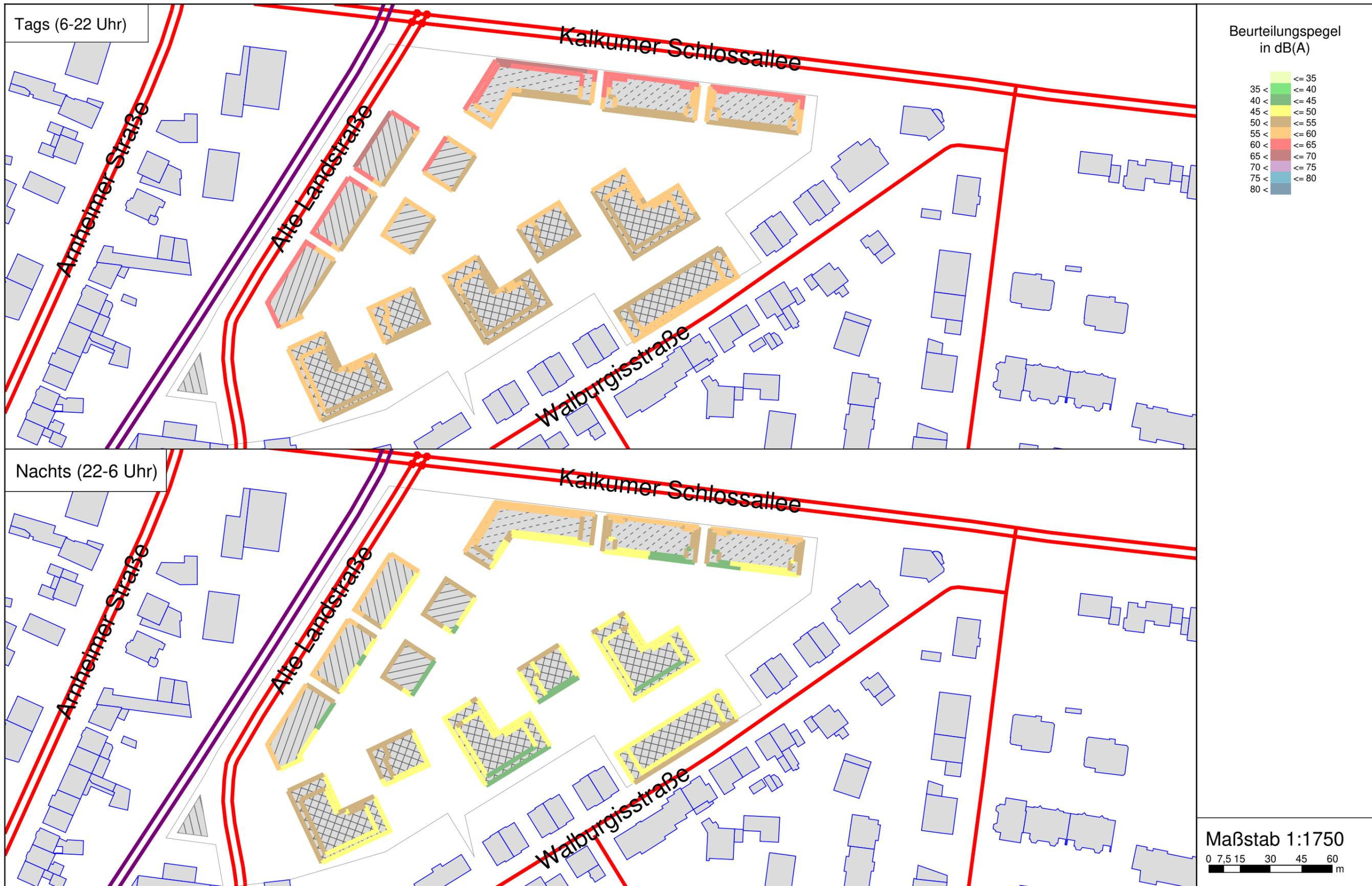
Anlage 5.2: Lageplan mit Kennzeichnung der Lärmpegelbereiche gemäß DIN 4109 (1989 und 2016) an den Baugrenzen durch Verkehrslärm in Form einer Gebäudelärmkarte bei freier Schallausbreitung im Plangebiet. Farbliche Kennzeichnung der Lärmpegelbereiche an den Gebäudefassaden nach DIN 4109 1989 und DIN 4109 2016
