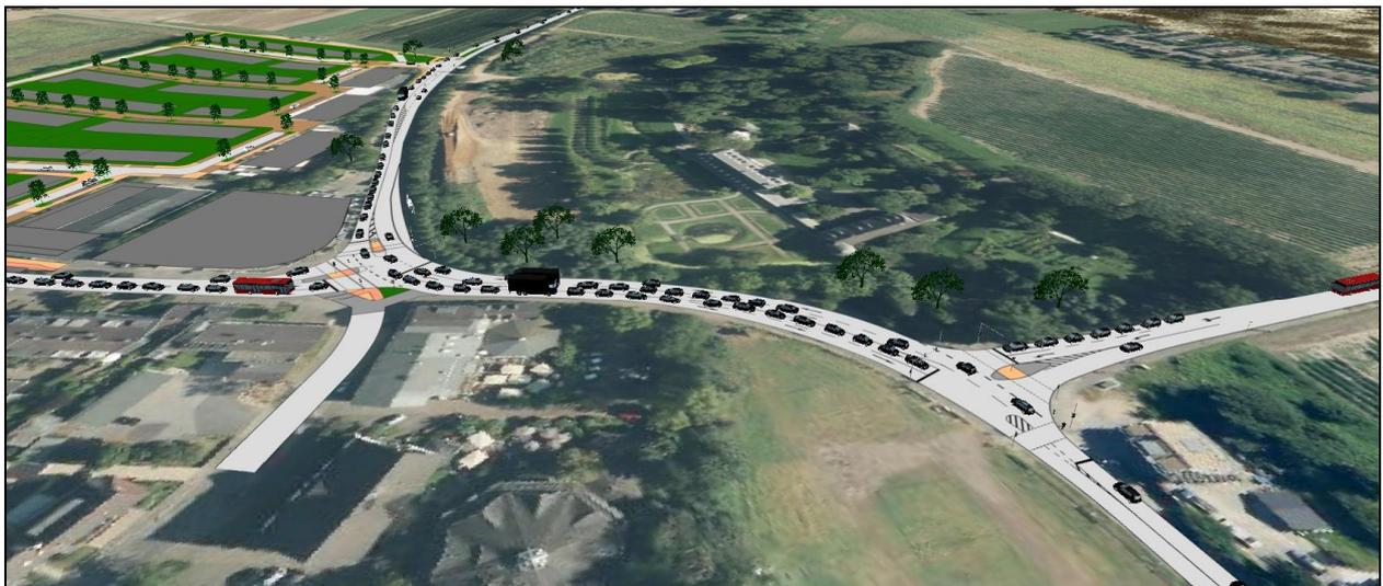
Abbildung 24: Ausschnitt aus der Verkehrsflusssimulation für die Abwicklung der zukünftigen Verkehrsnachfrage „im Bestand“
