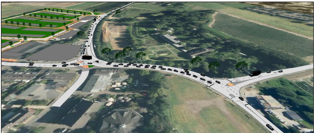
Abbildung 30: Ausschnitt aus der Verkehrsflusssimulation für die zukünftige Situation (optimiert)
