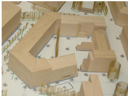
Bild 5.12: Photo des Windkanalmodells
