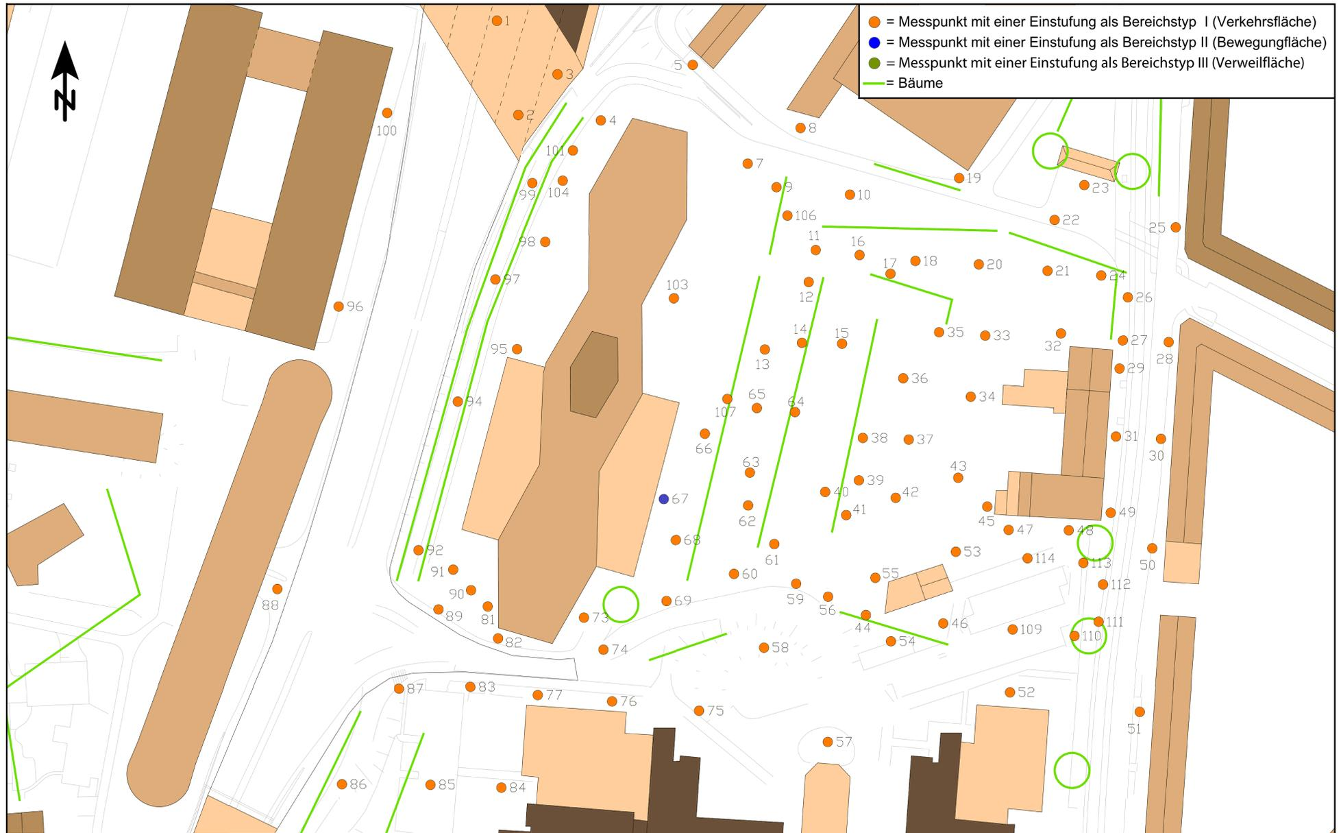
Ergebnis der Windkomfortmessung für den Bestand in Prozent der Überschreitungsstunden mit einer Windgeschwindigkeit > 5 m/s pro Jahr und Kennzeichnung von Messpunkten mit Windgefahren (Unterstrichungen)
