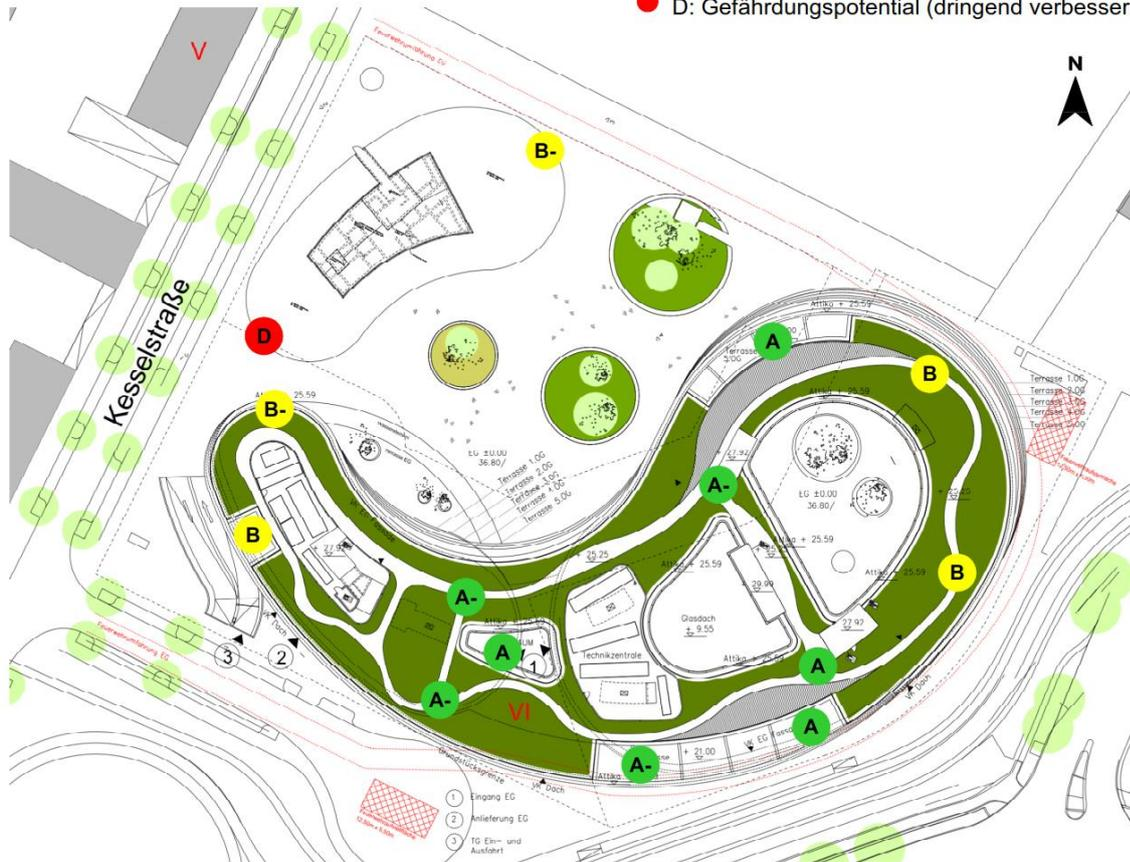
**Abb. 3.6:** Prognose der Komfortstufen bzw. Nutzungsmöglichkeiten der Dachterrassen der Trivago Gebäude BA 1 und BA 2 für Konfiguration 2
