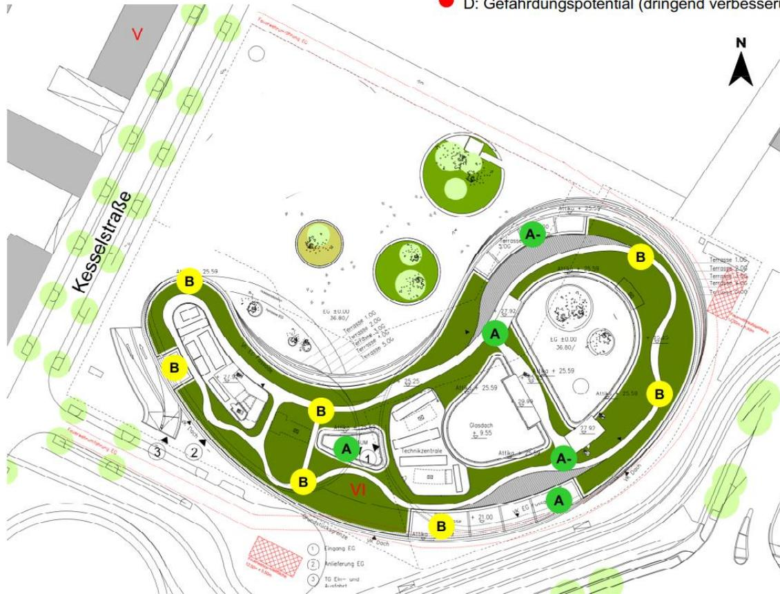
**Abb. 3.5:** Prognose der Komfortstufen bzw. Nutzungsmöglichkeiten der Dachterrassen auf dem Trivago Gebäude BA 1 für Konfiguration 1 (ohne BA 2)
