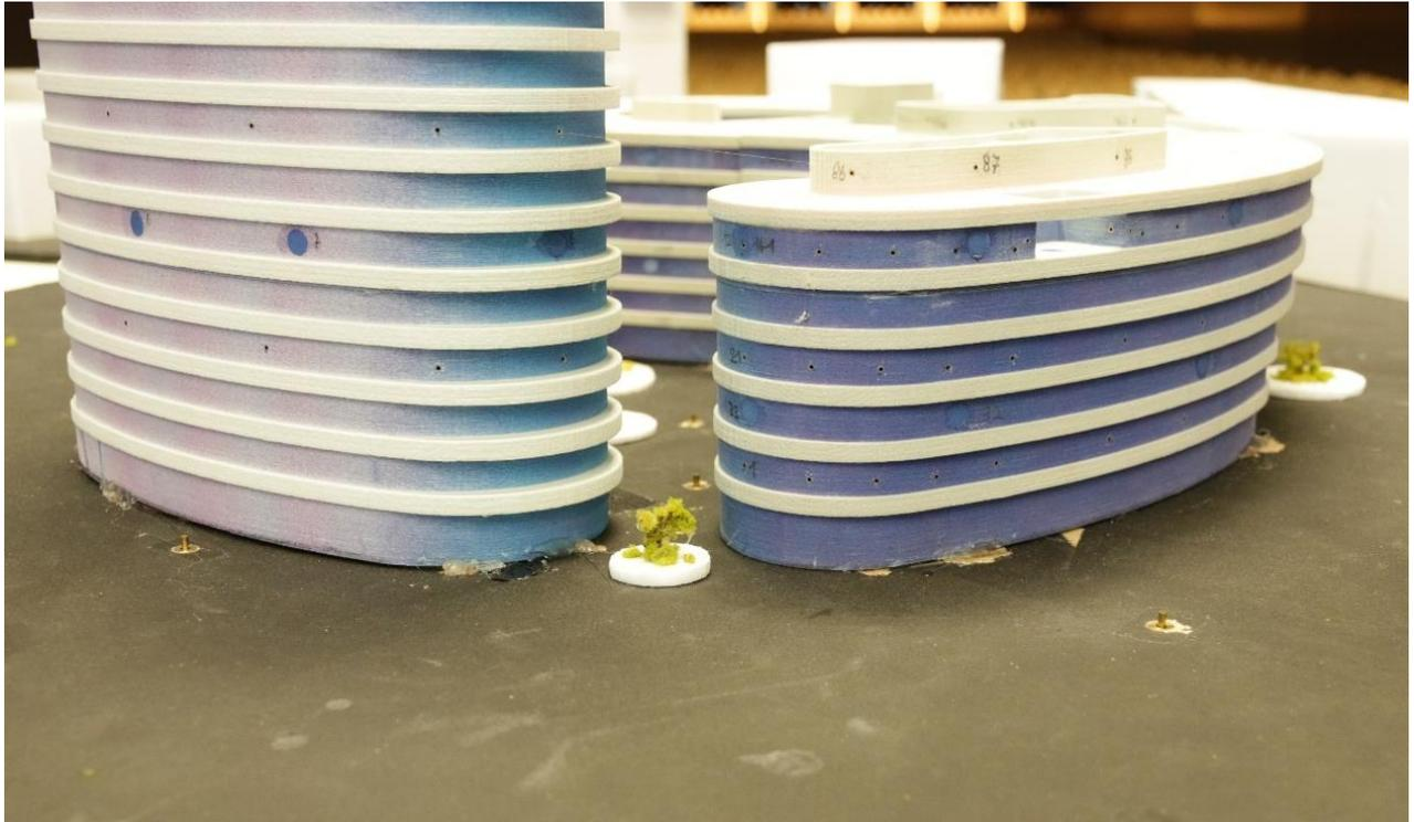
**Abb. 4.1:** Nahaufnahme des Windkanalmodells mit Verbesserungsmaßnahme 1 (Pflanzinsel westlich der Gasse zwischen BA 1 und BA 2).
