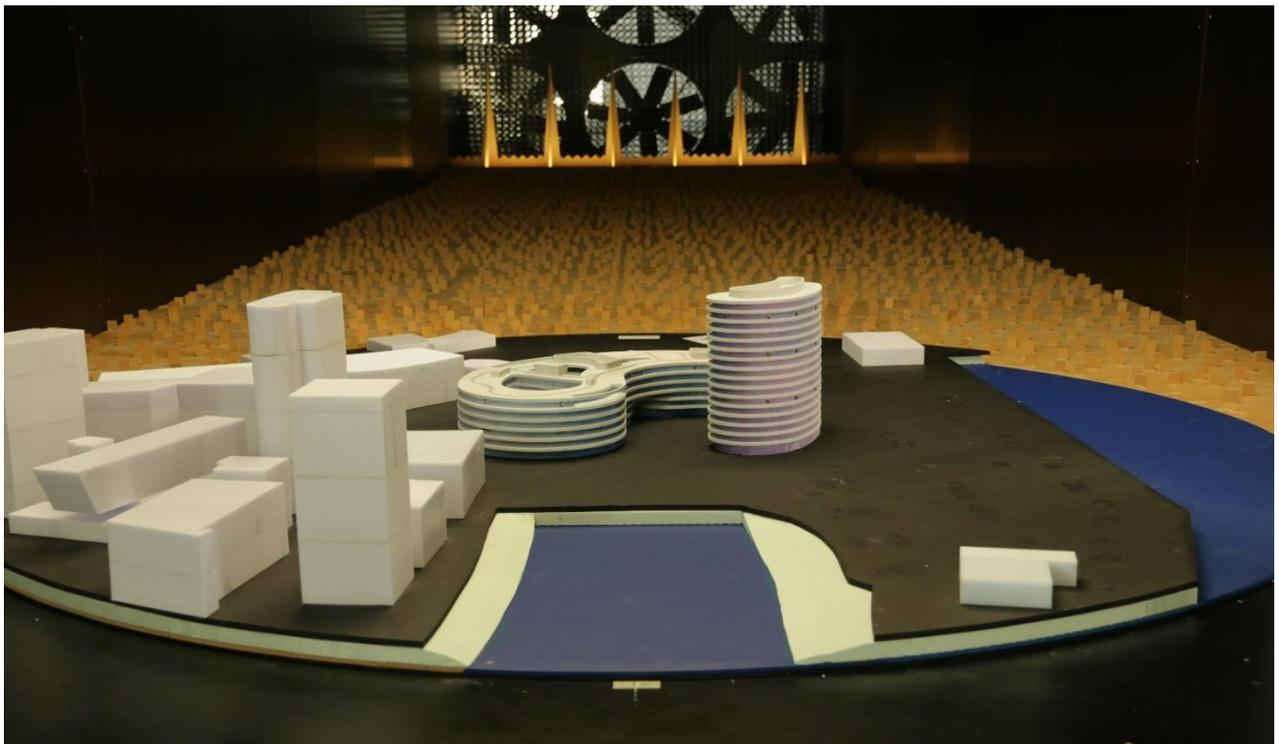
**Abb. 2.1:** Windkanalmodell im Grenzschichtwindkanal mit angrenzender Umgebungsbebauung im Istzustand. Oben ohne Hochhaus BA 2 (Konfiguration 1), unten mit Hochhaus BA 2 (Konfiguration 2)
