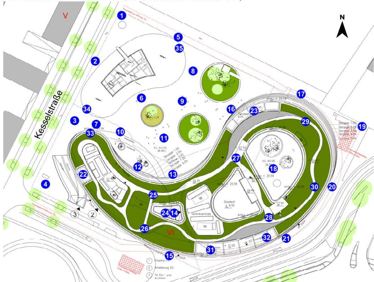
**Abb. 2.7:** Bezeichnungen und Positionen der Messstellen der Windkomfortmessung im bodennahen Außenbereich und auf den Dachterrassen
