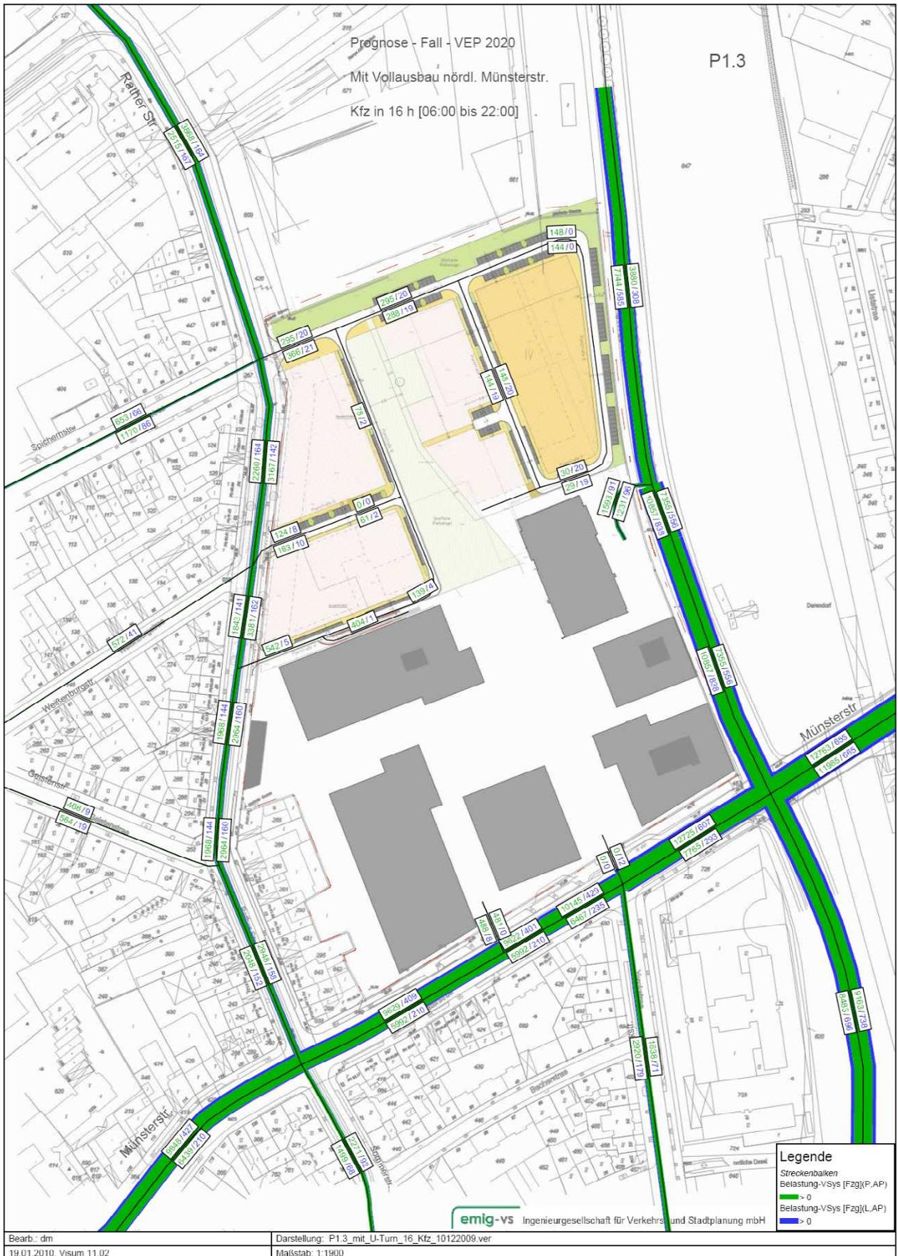
Abbildung 4.13: Prognose-Fall 1.3 (P1.3) / Verkehrsbelastungen DTV [Pkw/16h] und [Lkw/16h]
