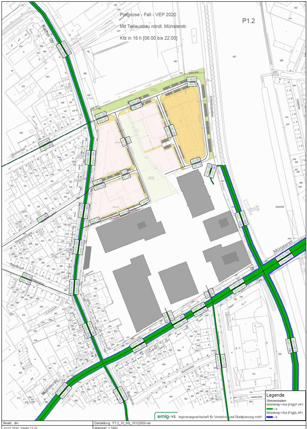
Abbildung 4.11: Prognose-Fall 1.2 (P1.2) / Verkehrsbelastungen DTV [Pkw/16h] und [Lkw/16h]
