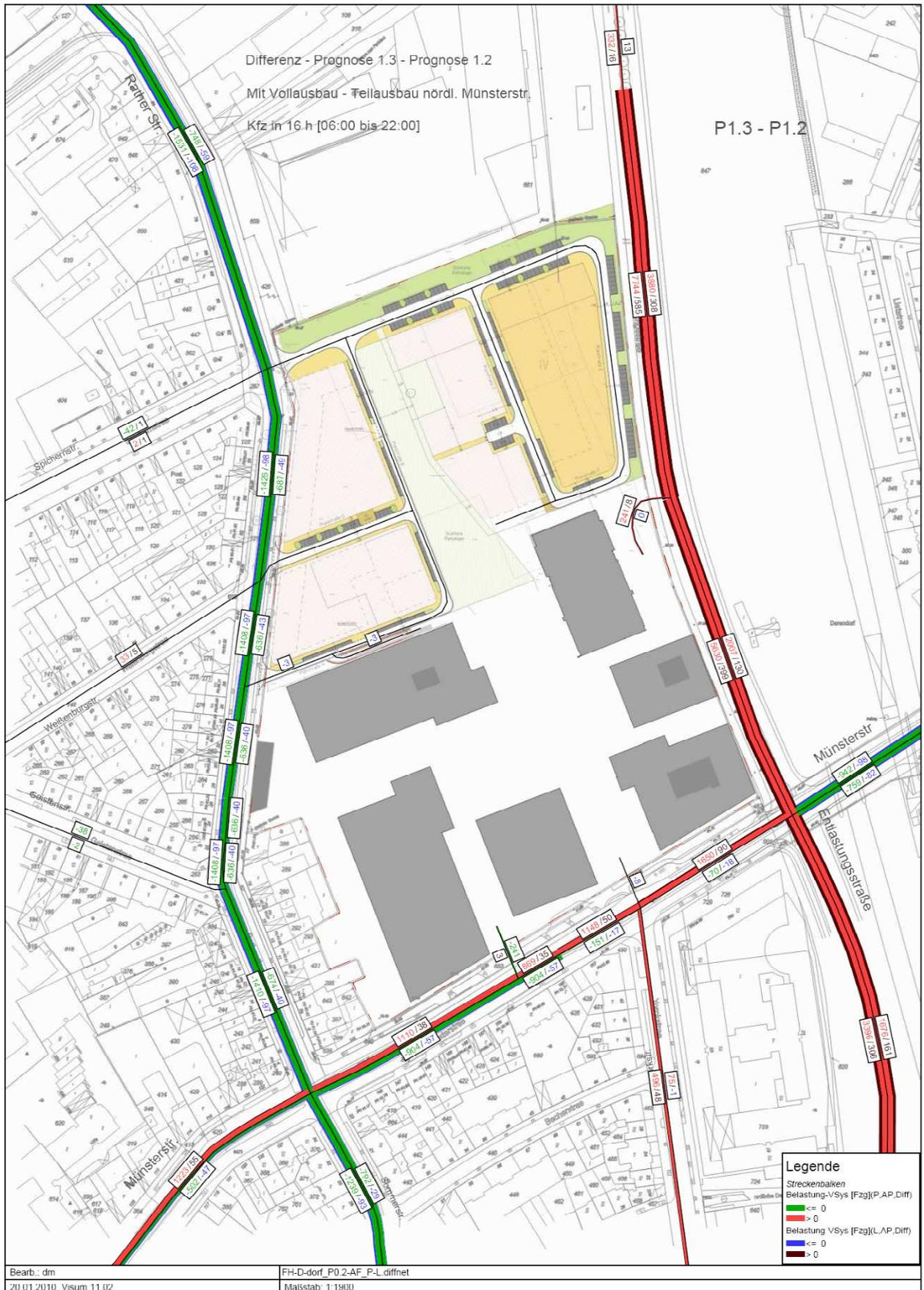
Abbildung 4.15: Differenzbelastung Prognose-Fall 1.3 abzgl. Prognose-Fall 0.3 DTV [Pkw/16h] und [Lkw/16h] - [Zunahme in rot, Abnahme in grün dargestellt]
