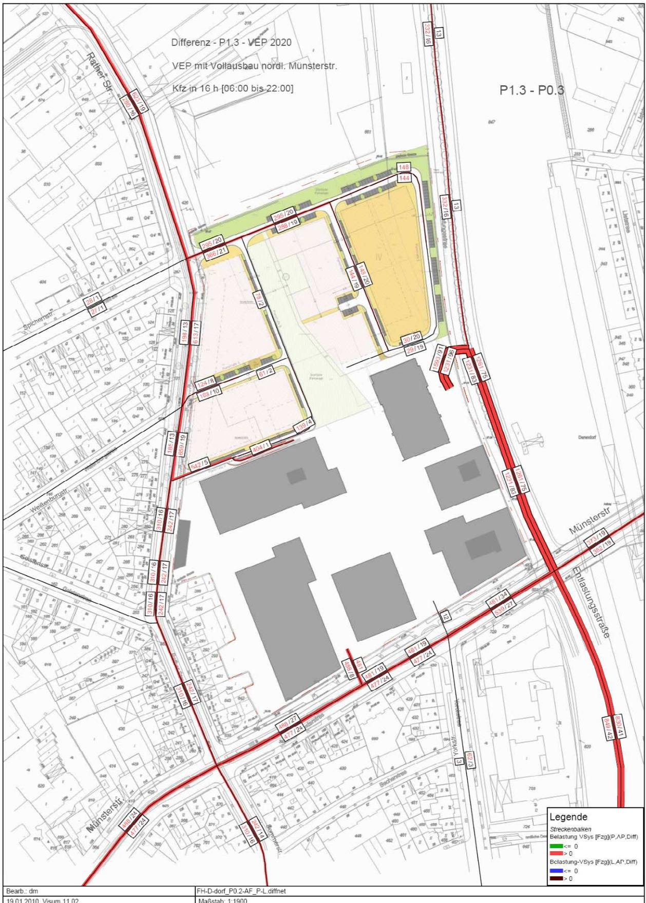
Abbildung 4.14: Differenzbelastung Prognose-Fall 1.3 abzgl. Prognose-Fall 0.3 DTV [Pkw/16h] und [Lkw/16h] - [Zunahme in rot, Abnahme in grün dargestellt]
