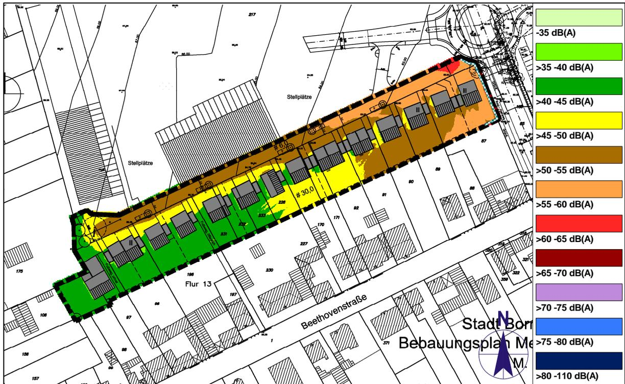
**Lärmkarte 3.MM.EG.T:** Lr der Verkehrsgeräusche zur Tageszeit im EG/Freifläche mit der 2,5 m LS-Wand, Maßstab 1:2.000
