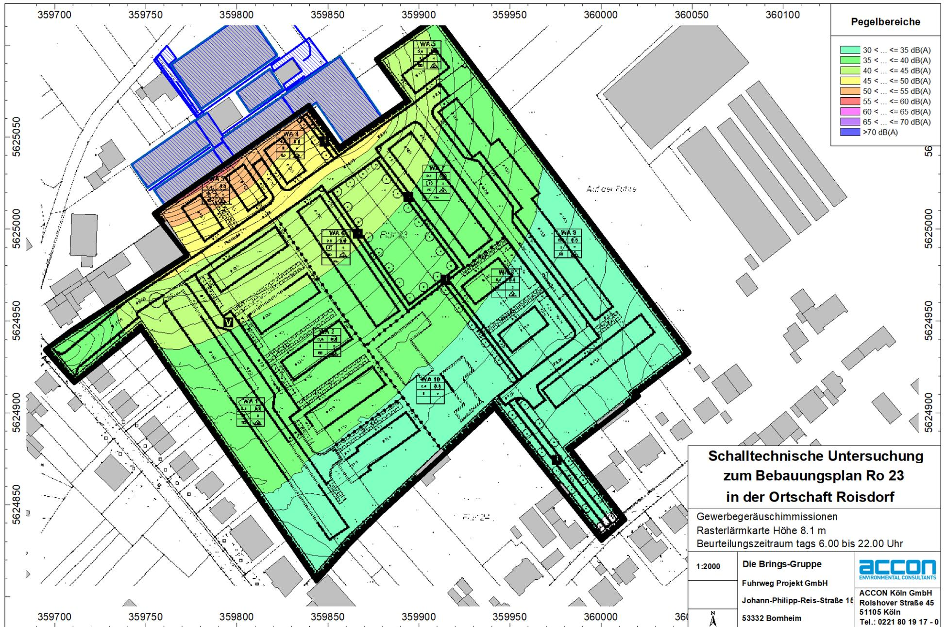
Abb. 4.3.1 Darstellung der maximalen Gewerbegeräuschimmissionen innerhalb des Plangebiets für eine Höhe von 8,1 m (2.OG)
