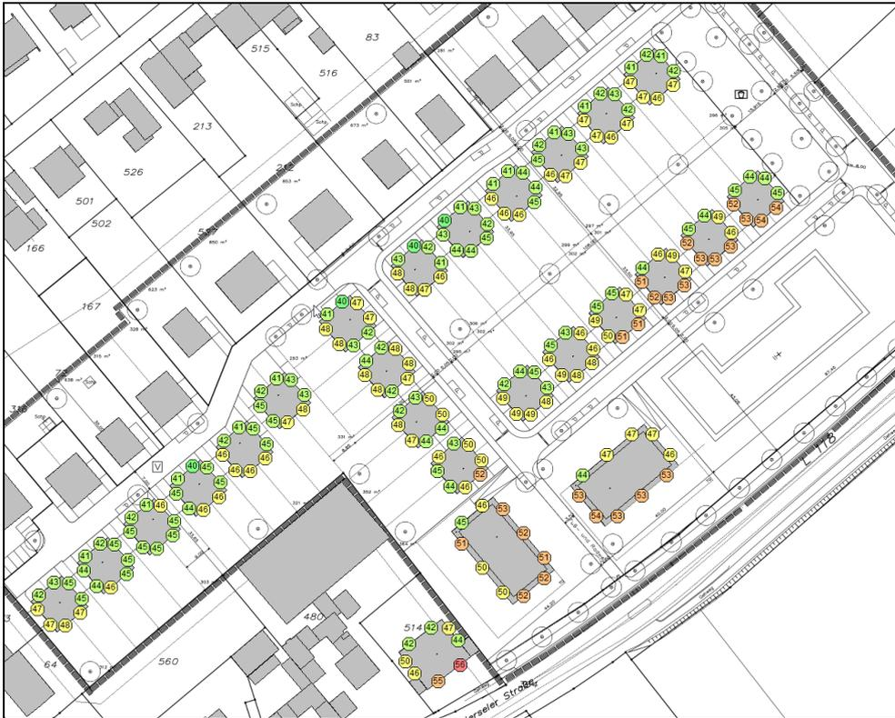
**Abb. 4.3.3** Gewerbelärmimmissionen bei fehlender Abschirmung durch das Gebäude mit gewerblicher Nutzung an der Herseler Straße, tags Höhe EG
