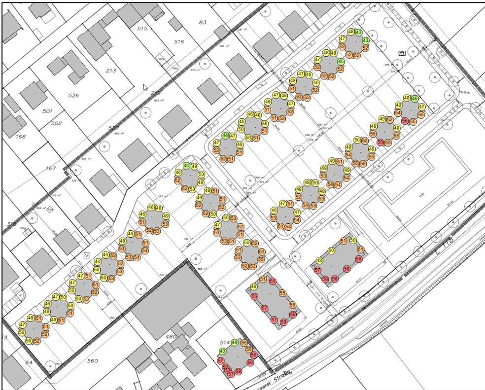
**Abb. 4.3.7** Gewerbelärmimmissionen bei fehlender Abschirmung durch das Gebäude mit gewerblicher Nutzung an der Herseler Straße, tags Höhe 2.OG
