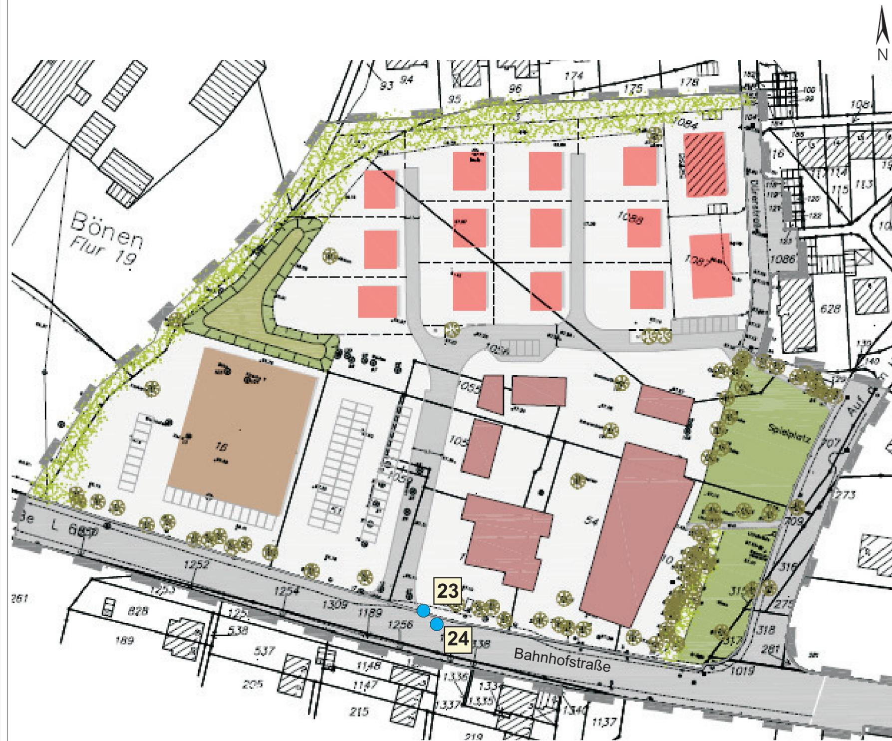
● Rammkernsondierung DN 80 mm
