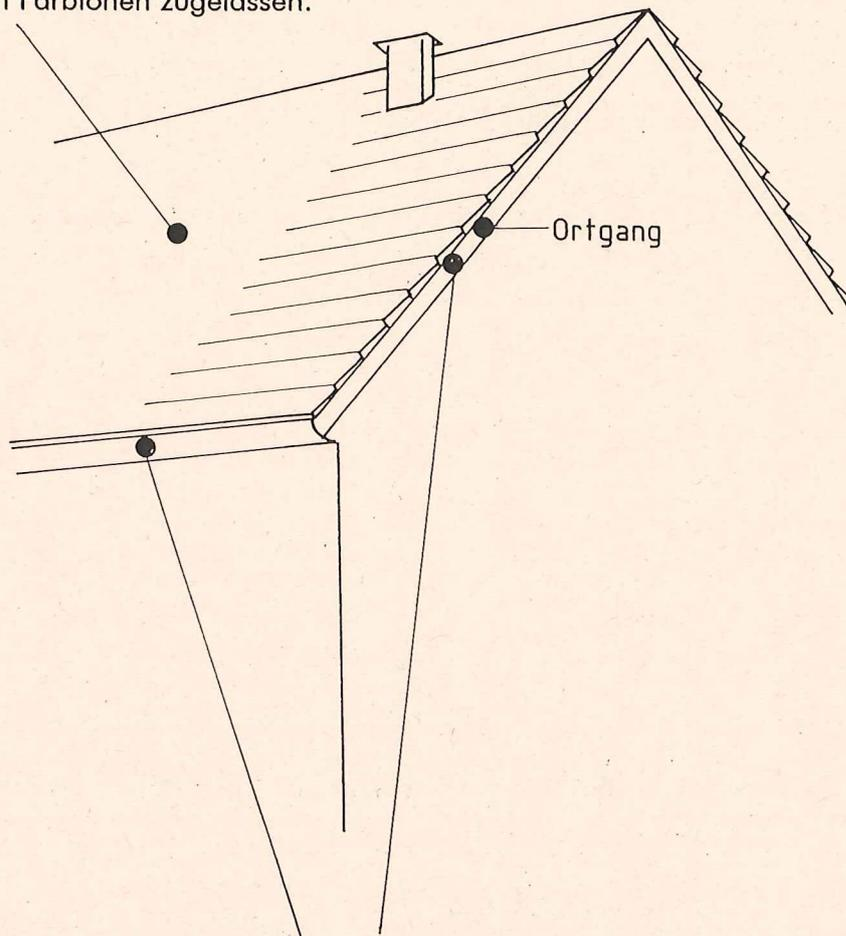
Das Verkleiden von Dachabschlüssen mit Schiefer oder anderen Materialien ist nicht zulässig. Der Ortgang ist in der ursprünglichen Art als Ortgangputzband mit geringfügigem Dachziegelüberstand oder mit Ortgangziegeln ohne weitere Verkleidung auszuführen.
