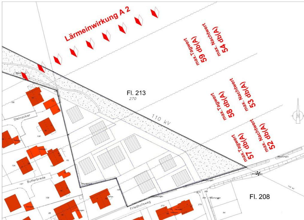
[Abb. 3] schematische Darstellung der Lärmimmissionen
