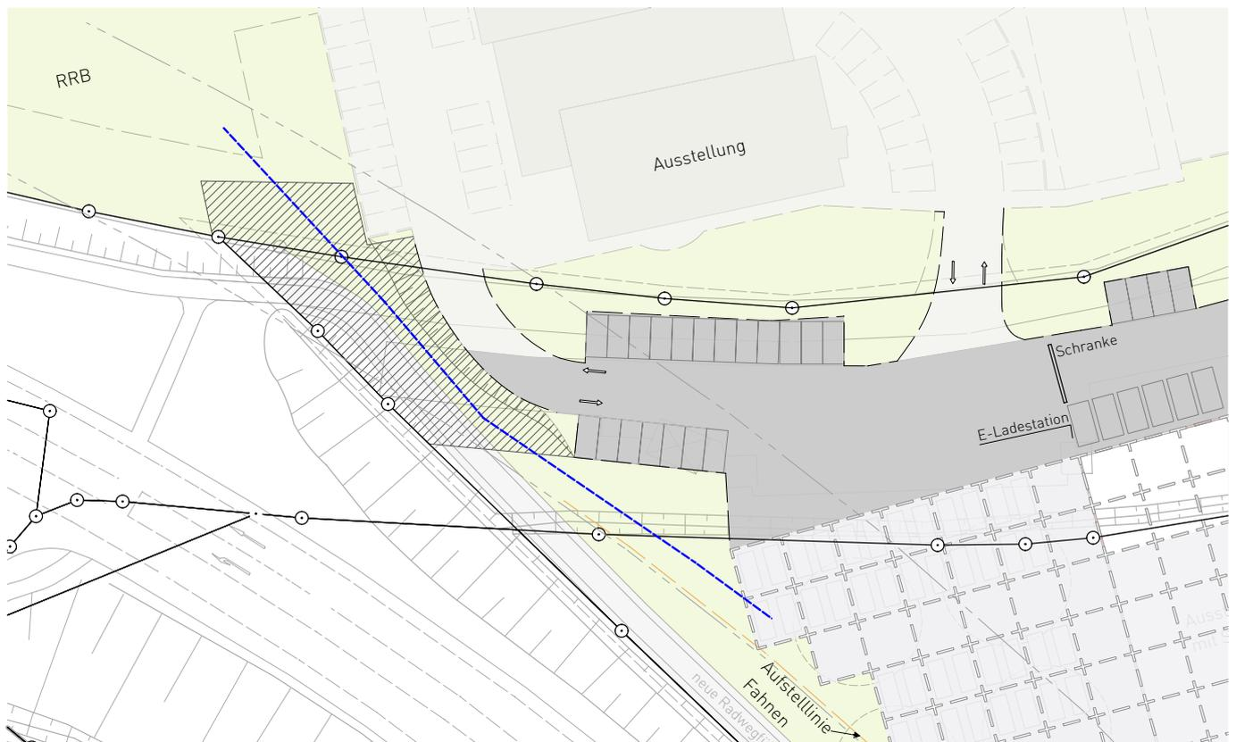
Ausschnitt aus dem V + E Plan (Stand 26.10.2016): Darstellung der gepl. Geländeerhöhung zzgl. der geplanten RW-Leitung
